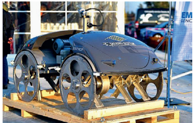
Abb. 3: Elektrischer Wenderoboter „Bottrop“ zur Grundsteinlegung der solarthermischen Klärschlamm-trocknung am 31. Oktober 2019 (Quelle: Emschergenossenschaft, Kirsten Neumann)
